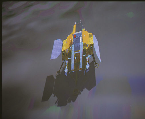
嫦娥四号探测器展开太阳翼(示意图)
