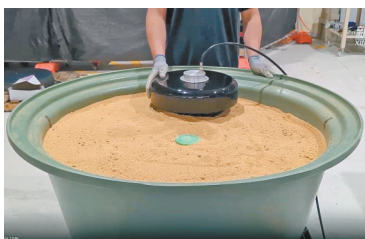
磁共振技术可以检测出地雷中炸药的分子特征，比目前使用的金属探测器更可靠。 视频截图 新华社发
